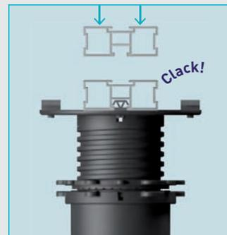
Simplymente presiona el rastrel sobre el clip y quedará anclado a éste de forma segura.
