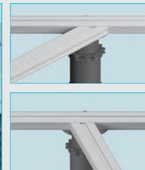
El clip para rastrel puede ser girado 360° para instalar el rastrel con los grados deseados y así poder construir un sólido armazón de aluminio.
