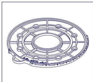
El regulador de inclinación permite conseguir el perfecto nivelado del plot sobre formaciones de pendiente, evitando así que aparezcan cejas entre baldosas.
