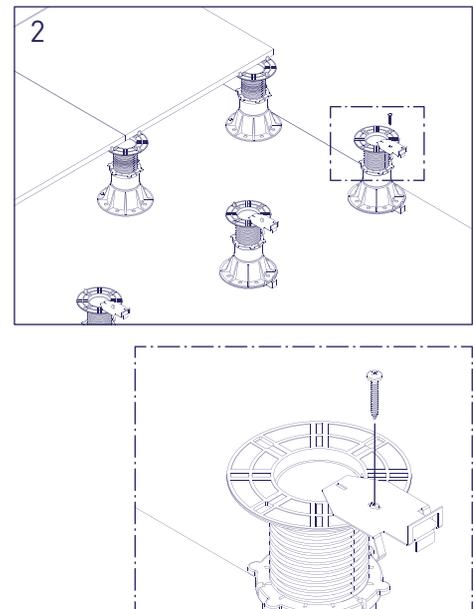
[fig.1] A los Plots que colocamos para hacer el cierre se les retiran las pestañas oportunas. Disponer las tres partes del Kit de cerramiento vertical en cada pedestal: Base, clip superior y clip
