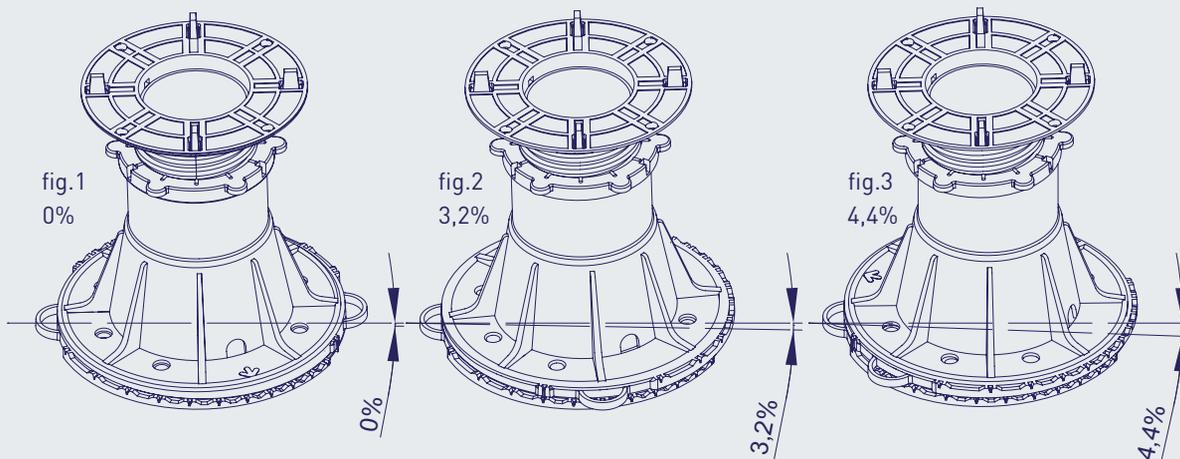
Al enfrenar dos Reguladores de Inclinación, sus caras se posicionan en paralelo con un 0% de pendiente. Girando las pestañas se incrementa la pendiente progresivamente.
