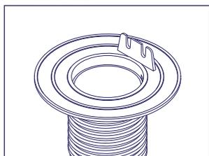
**Material:** Polipropileno con carga mineral.
