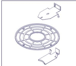
El Kit de cerramiento vertical permite realizar un frente o tabica vertical entre la base de apoyo y el embaldosado. Está limitado a baldosa de 18 a 20mm de espesor.
