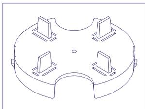
**Material:** Polipropileno con carga mineral
