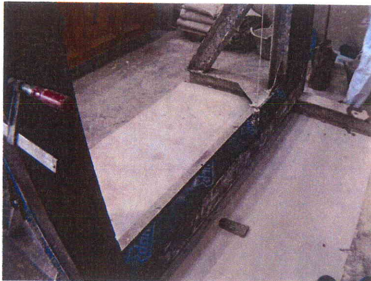
Figura 2- Banda de neopreno para el montaje de los paneles
