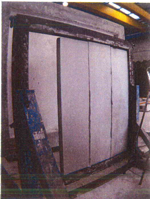
Figura 3 - Colocación de los paneles de yeso para el levante de la muestra
