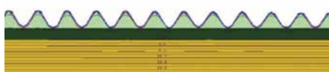
Distribución de isotermas a través de la solución con cámara de aire
