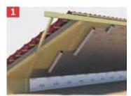
Desplegar la lámina barrera de vapor ONDUTISS® BARRIER REFLEX sobre los rastreles por la parte caliente de la cubierta (debajo de la capa aislante). Comenzar a instalar desde la parte inferior hacia a cumbrera, quedando a parte impresa con el logo visible. El solape está indicado mediante líneas o con el logo impreso.
