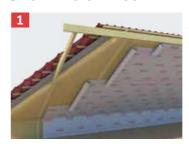
Extienda la lámina a prueba de vapor ONDUTISS® BARRIER sobre el soporte de la cubierta,se ha de colocar en la cámara caliente del edificio, antes del aislamiento. Empiece a colocar la membrana de alero a cumbrera, siempre con la cara impresa hacia el exterior. El solape entre láminas está indicado mediante líneas longitudinales impresas en el producto.
