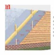
Fijar ONDUTISS\*AIR con rastreles a la estructura. Instalar los elementos de revestimiento (paneles de fachada, placas metálicas, etc.) La cámara de ventilación entre ONDUTISS\*AIR y el revestimiento debe de ser de al menos 3 cm.
