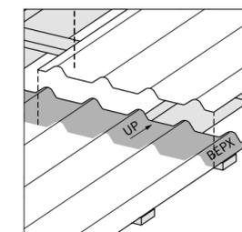
• Solape 12 cm, con líneas estampadas. Las marcas UP indican la parte superior de las placas para facilitar su instalación.
