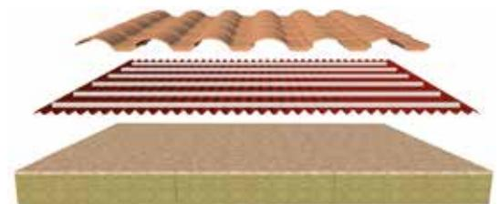
\*Se recomienda colocar la lámina barrera de vapor ONDUTIS BV previa instalación del panel sándwich aislante ONDUTHERM BASIC sobre el forjado.
