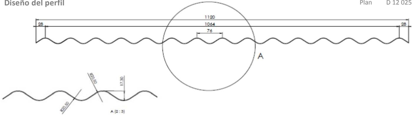
Las placas de poliéster Onduline PLR Mini Onda están constituidas por resina de poliéster reforzada con fibra de vidrio. Las placas de Onduline PLR Mini Onda están protegidas por ambas caras con un gel coat específico para evitar el desfibrado a lo largo del tiempo y protegidas contra los rayos UV, garantizando la estabilidad de la transmisión luminosa en el tiempo.
