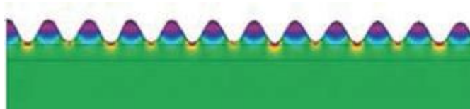
Distribución de flujo de calor a través de la solución de cámaras de aire
