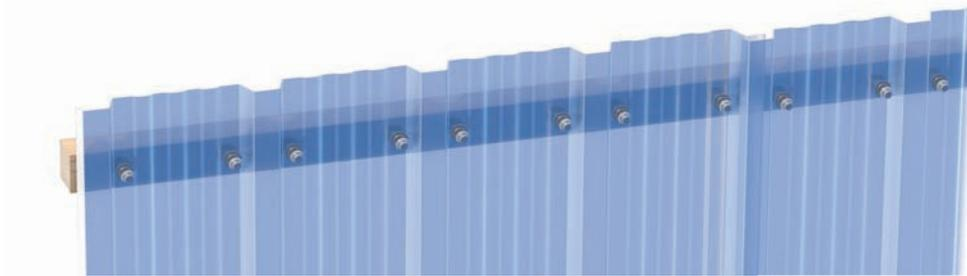
*Fijación en el canal del perfil (En condiciones adversas: dos fijaciones por cada canal).*
