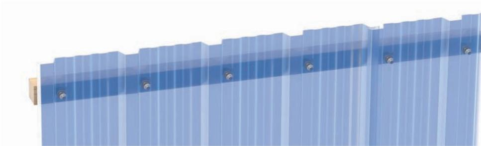
*Fijación en el canal del perfil (En condiciones normales: una fijación por cada canal).*
