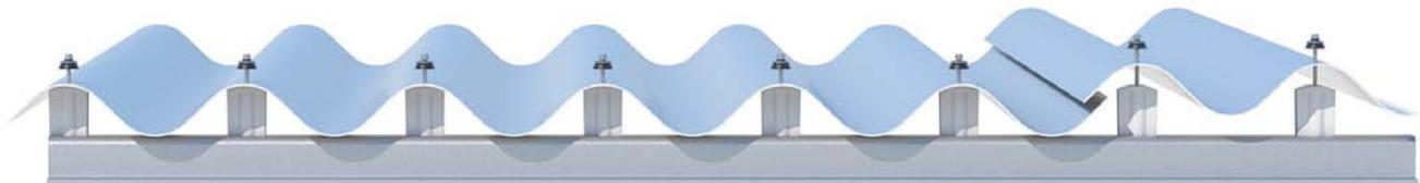
En el alero se debe instalar una fijación en el alto de cada onda.
