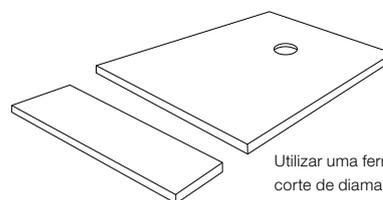
Utilizar uma ferramenta de corte de diamante
