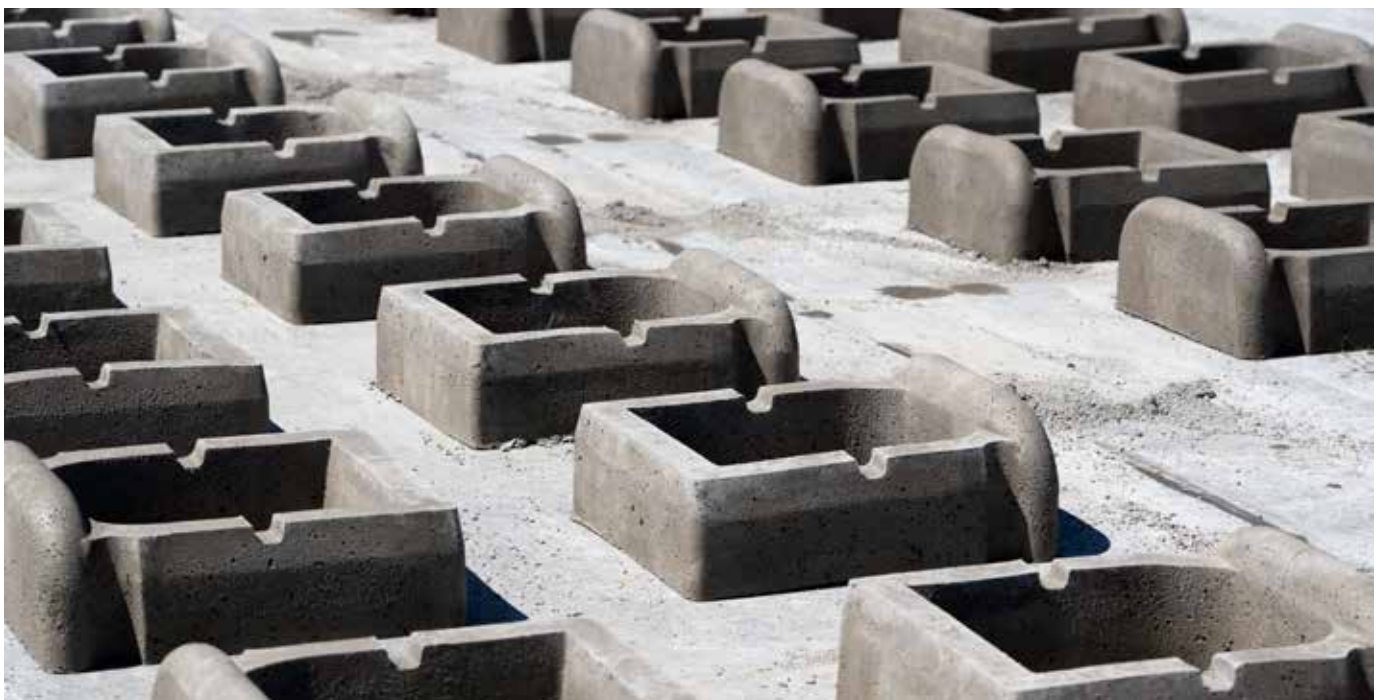
Proceso de secado de piezas componentes de un muro Alpenstein.
