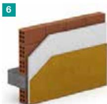
6 Aplicar **RE VAT MINERAL** armado com rede de fibra de vidro diretamente sobre **PROPAM TERM 50**. Quando terminada, a espessura recomendada para esta camada é de 10 mm.
