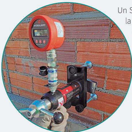
Un SATE eficaz, seguro y durable es cualquiera de los escogidos dentro de la familia **PROPAM® AISTERM**, con los que **realizamos el ensayo de extracción** para la comprobación de la resistencia a tracción de las fijaciones **PROPAM® AISTERM**.
