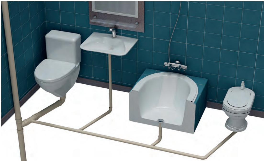
(Fig. 2). Desagüe de aparatos sanitarios mediante sifón individual
