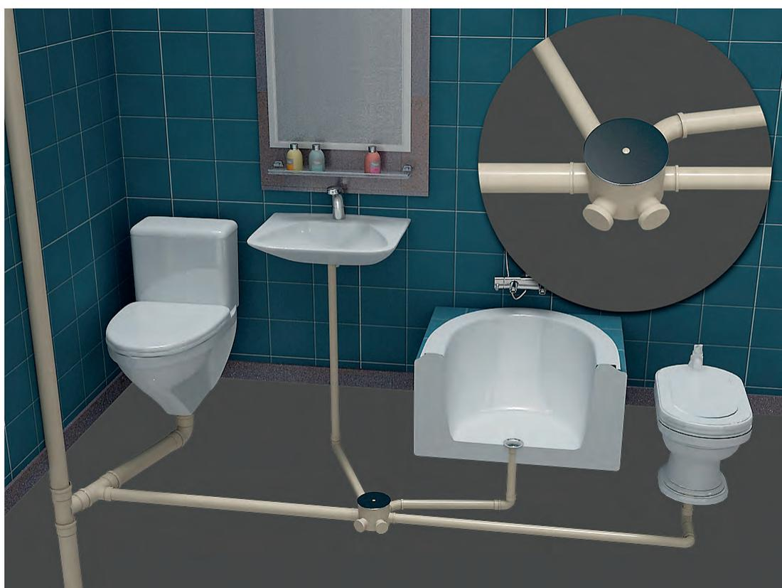
(Fig. 3). Desagüe de aparatos sanitarios mediante bote sifónico
