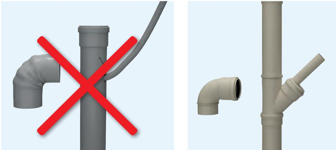
(Fig. 5). Utilización de piezas inyectadas
