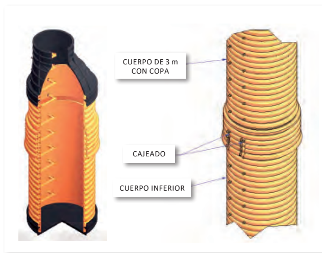
POZOS PROFUNDOS MEDIANTE 2 MÓDULOS
