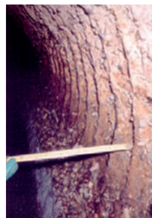
EFECTOS DE LA CORROSIÓN EXTERIOR E INTERIOR EN TUBERÍAS.
