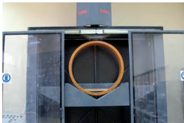
ENSAYO DE RIGIDEZ DE UN TUBO FLEXIBLE.
