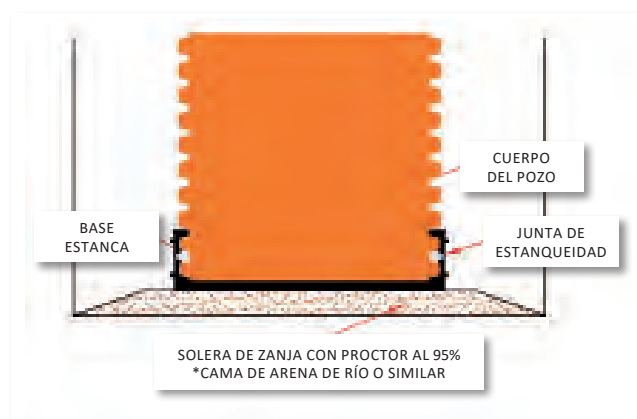
ACABADO DEL FONDO DEL POZO CON BASE ESTANCA.
