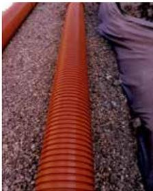
Doble pared (interior lisa, exterior corrugada) soldada por termofusión durante el proceso de fabricación de extrusión en continuo. El equipo ranurador, sincronizado con el de corrugación, realiza las ranuras para el drenaje en los valles de la tubería, que son las zonas de menor espesor, por lo que se minimiza la retención al paso del agua.
