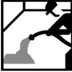
3 Puesta en obra mediante vertido o bombeo del material sobre el puente de unión en estado fresco y nivelación (ver nota).
