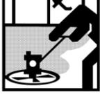
4 Compactado, regleado y fratasado de MasterTop 450 PG seguido de los diversos procesos de pulido mediante helicóptero hasta conseguir el acabado requerido.
