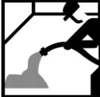
3 Puesta en obra mediante vertido o bombeo del material sobre el puente de unión en estado fresco y nivelación (ver nota).
