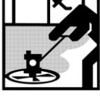
4 Compactado, regleado y fratasado de MasterTop 200 PG seguido de los diversos procesos de pulido mediante helicóptero hasta conseguir el acabado requerido.
