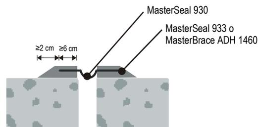
Para el empalme entre bandas se deben solapar unos 3 cm como mínimo, redondear las esquinas y desbastar las superficies a solapar con papel abrasivo (tamaño de grano de 150), eliminar la suciedad generada y soldar con aire caliente hasta llegar a la temperatura de fusión 270°C aprox. pasando el rodillo (ver esquemas).
