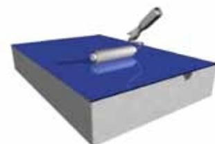
6. Aplicar el rodillo estriado para que el exceso de saturación salga a través de las fibras de la hoja.
