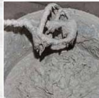
Mezcla concluida de Planitop HDM Restauro
