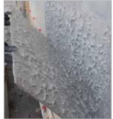
Fig. 4.13 - Capacidad de impregnación del adhesivo con tecnología ULTRALITE
