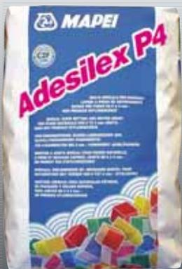
limpio) con 5-5,5 litros de agua limpia por cada saco de 25 kg hasta obtener una pasta homogénea y sin grumos; después de 3 minutos de reposo, mezclar nuevamente y la pasta estará lista para su aplicación. La mezcla de **Adesilex P4** obtenida permanece trabajable alrededor de 60 minutos a +23°C y 50% de humedad relativa.
