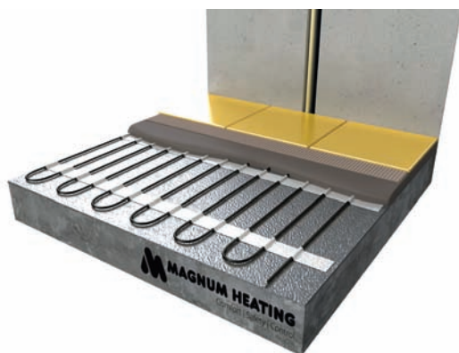
Instalación con aislante MAGNUM y cinta
