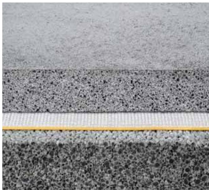
La solución prevé la colocación de un recredido aislante superligero (que permite integrar los conductos de instalaciones), sobre el que se realiza el sistema de calefacción de suelo formado por paneles aislantes rígidos y por tuberías o cables eléctricos inmersos en una solera de elevada conductividad térmica.
