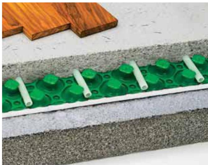
La solución permite aligerar un forjado abovedado y prepararlo para la colocación del solado. En los huecos presentes por encima de la bóveda se realiza un relleno superligero a base de Arcilla Expandida hasta conseguir una superficie regular para la siguiente puesta en obra de una solera ligera o de una losa de hormigón ligero estructural. La solución puede completarse con varias capas opcionales para responder a exigencias de carácter acústico, térmico y de control de la humedad.
