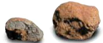
Arcilla Expandida Laterlite Estructural (alta resistencia).
