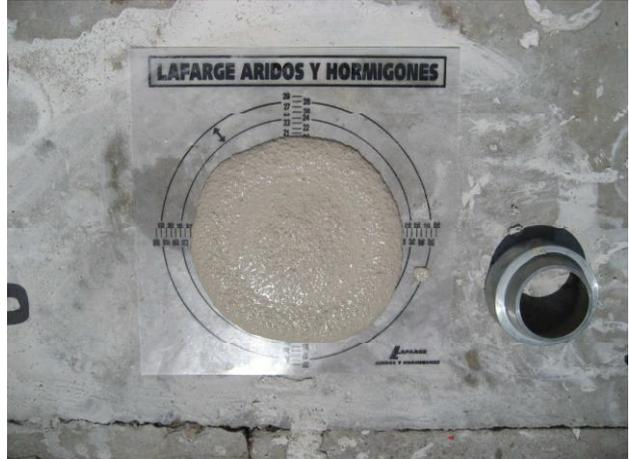
La fluidez se determina poniendo una muestra de material en el anillo colocado sobre la lámina de examen en una escala de hasta 30cm de diámetro. El anillo de metal lleno de Agilia Suelo A se coloca en la lámina de examen y luego se levanta.
