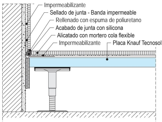
F181.es-V4 Montaje de instalaciones con pedestal bajo junta
