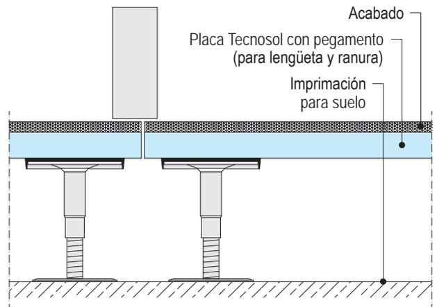
F181.es-V15 Ejemplo: Instalación de un tapa juntas
