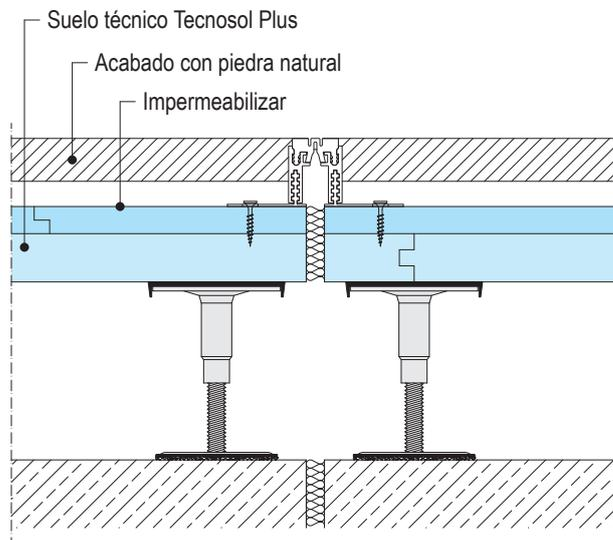
**F182.es-V41** Suelo técnico Tecnosol Plus 25+18 Junta de control con protección al fuego
