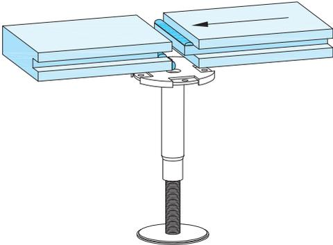
Colocar la lengüeta despues de haber aplicado el pegamento de juntas Tecnosol en la ranura
