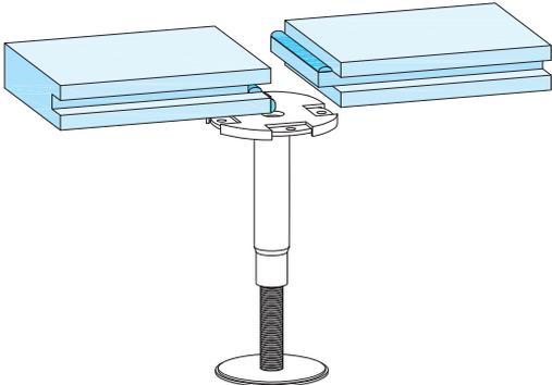
Situar los pedestales centrados bajo cada junta. Poner el pegamento juntas Tecnosol en la lengüeta y en la ranura en la que se va a colocar
