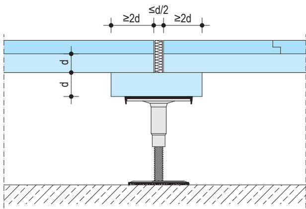
**F182.es-V41b** Suelo técnico Tecnosol Plus 32+18 Junta de control con protección al fuego
