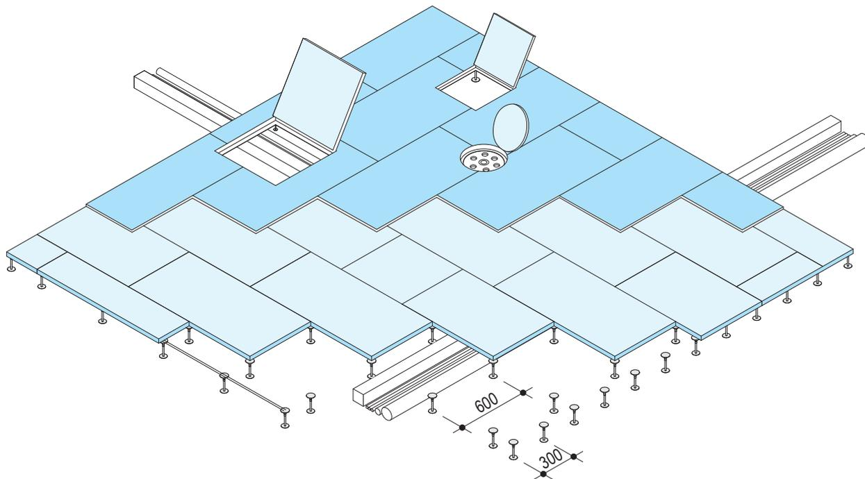
En el perímetro colocar pedestales a una distancia de 300 mm. Refuerzo adicional, rango de carga 5
