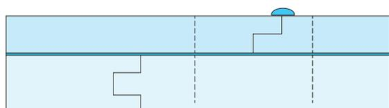
Colocar inmediatamente la segunda placa Tecnosol LEP sobre el pegamento superficial Tecnosol, presionar y grapar
