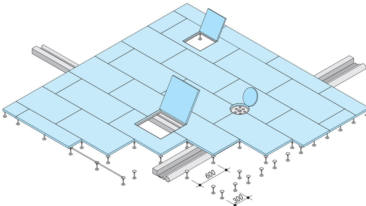
En el perímetro colocar pedestales a una distancia de 300 mm. De esta manera se obtiene un rango de carga 5
