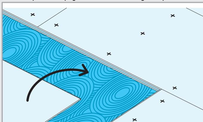
Continuar aplicando el pegamento superficial Tecnosol y seguir colocando las placas LEP para luego fijarlas con una grapadora
