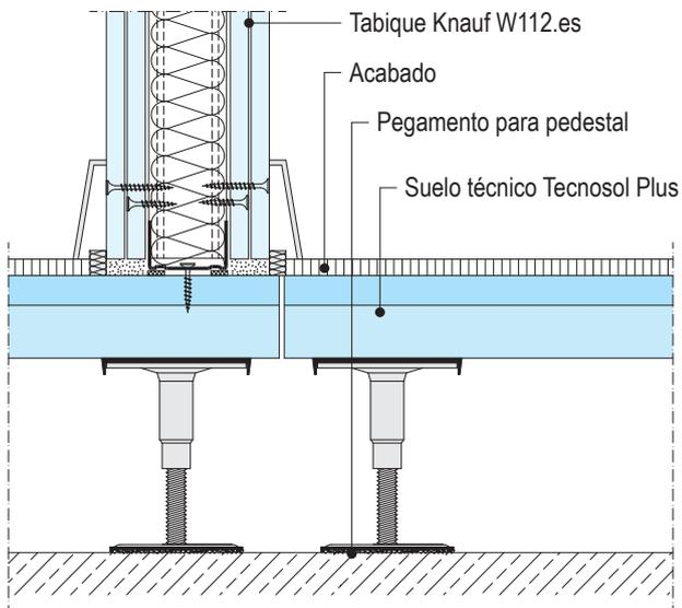
**F182.es-V40** Suelo técnico Tecnosol Plus 32+18 Ejemplo: Junta de suelo técnico sobre junta de dilatación
