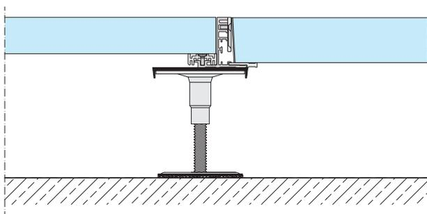
Instalación de la tapa universal uno para suelo Tecnosol de 28 y 32 con kit distanciador
