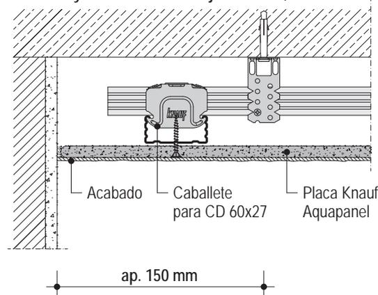
D282a.es-C2 Junta Longitudinal con anclaje directo
