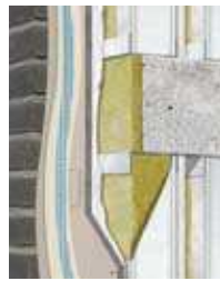
Montante doble + placa intermedia
