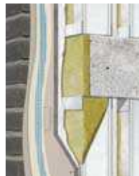
Montante doble + placa intermedia
