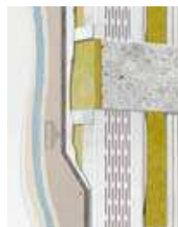
Montante sencillo entre forjados: perfil ranurado
