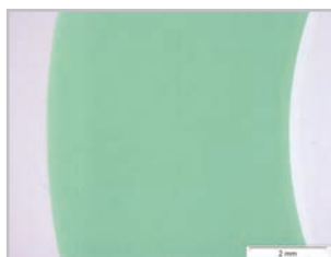
Observación estereomicroscópica de secciones de tubo con una mala dispersión y una buena dispersión del pigmento y aditivos
