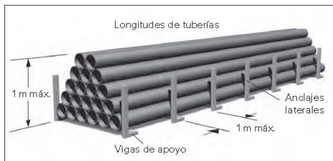
Imagen 18. Almacenamiento de tuberías individuales
