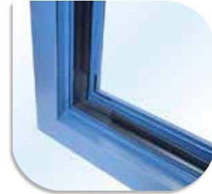
No se debe colocar goma exterior en el marco, para permitir que el aire circule por la cámara exterior, ayudando así a la junta central a presionar sobre su apoyo en la hoja, y permitiendo desaguar, ya que de esta forma no se crea una cámara de vacío.
