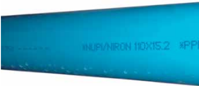
Estado de tubería niron con condensación superficial.
