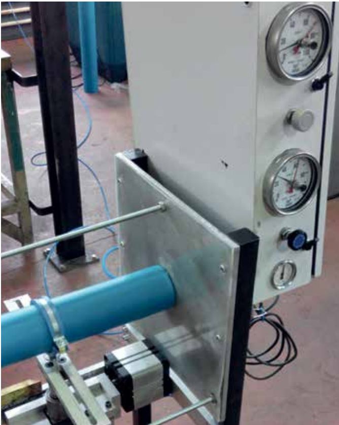
Superación de los test de ensayo de deslizamiento, asegurando el perfecto comportamiento ante dilatación longitudinal como perimetral.
