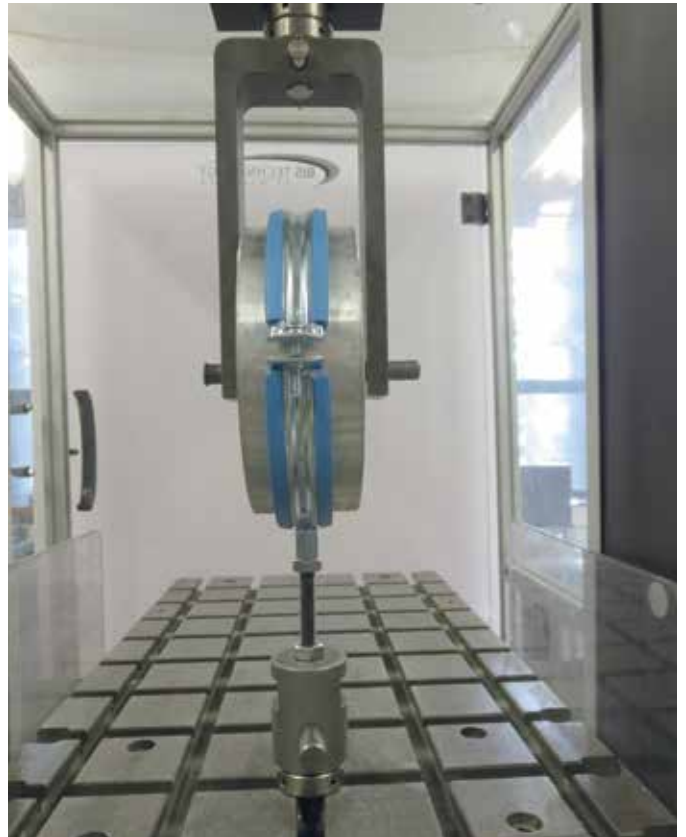
La resistencia a tracción de las abrazaderas ha sido comprobada verificando su comportamiento con carga.
