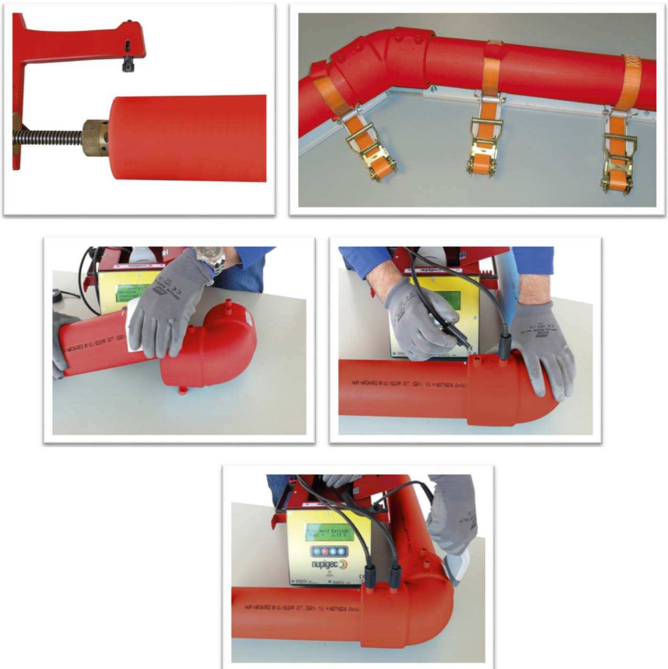
Figura 4. Soldadura con electrofusión
