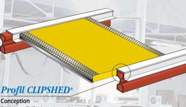
Le profil CLIPSHED est un profil PVC à structure alvéolaire doté d'ailettes latérales supérieures. Il s'adapte à toutes les formes de pannes légères. Il est posé à cheval et fixé sur les pannes légères avant la pose du bac acier de couverture.
