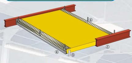
L'élément est disposé à la fois sur les ailes inférieures des pannes et les entretoises fixées aux pannes, à l'aide d'équerres anti-soulèvement. Les panneaux sont immobilisés par des cavaliers de blocage.
