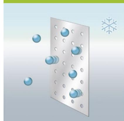
Con la humedad relativamente baja que predomina en los meses más fríos del año, la estructura molecular de la membrana cambia para incrementar la resistencia a la difusión de la membrana VARIO KM Duplex UV hasta una difusión por la capa de aire de solo 5 m. Con ello se evita que la humedad de la estancia penetre en la estructura.
