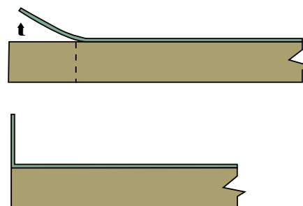
Uma vez colocados os **Painéis PST** e seladas as suas juntas proceder-se à colocação do soalho evitando que este toque a parede, recorrendo-se a cunhas de 8mm de espessura e que são retiradas na hora de colocação o rodapé, o qual deve ser colocado de forma a evitar o contacto com o pavimento colmatando as juntas com uma massa elástica ou massa adequada para juntas.
