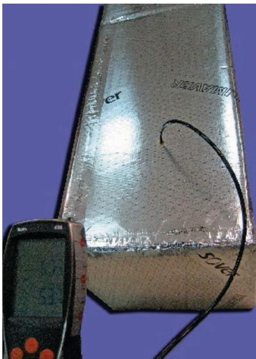
Probeta **CLIMAVER** para el ensayo de resistencia a la Presión según UNE-EN.
