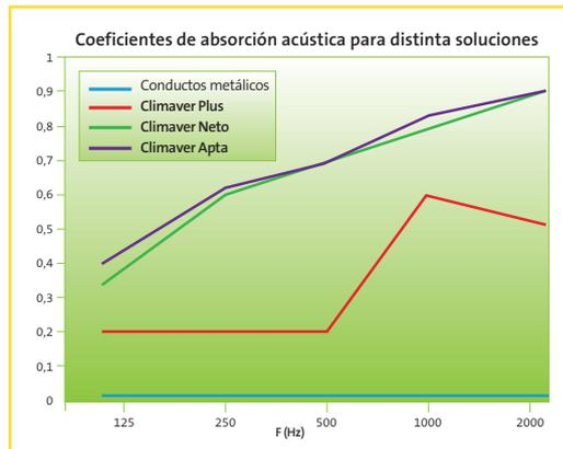
Estos valores del coeficiente de absorción, por aplicación de la fórmula anterior, otorgan distintos valores de atenuación en el conducto, en función de la sección del mismo.
