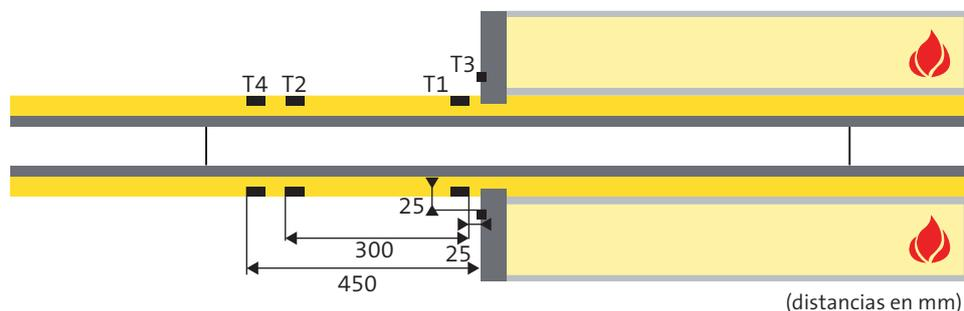
La resistencia al fuego a nivel del criterio de aislamiento corresponde al tiempo en minutos completos durante el cual la muestra continúa manteniendo su función separadora durante el ensayo sin que:
