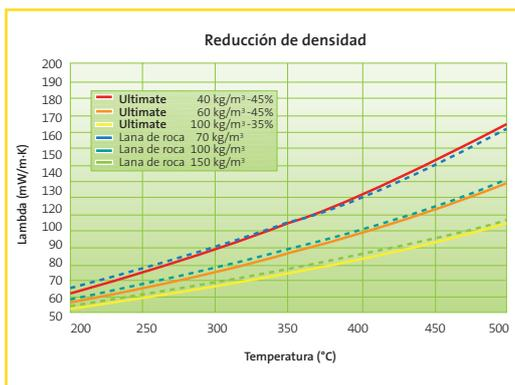
La innovación del proceso THA y de la composición **ISOVER Ultimate** ha permitido sacar un producto único en el mercado que combina flexibilidad y ligereza con altas prestaciones térmicas a elevadas temperaturas y resistencia al fuego.
