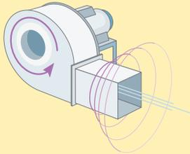
Transmisión de ruido debida al propio sistema de ventilación.
