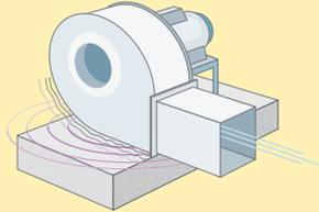
Transmisión de ruido por la estructura a causa de la vibración.
