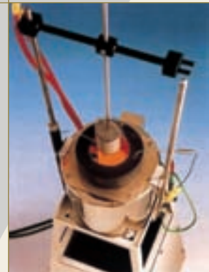
Bomba calorimétrica (A2)
