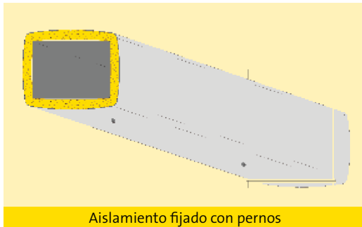
Aislamiento fijado con pernos
