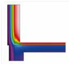
Termografía de la fachada con aislamiento por el exterior tipo SATE.
