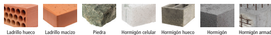
Ladrillo hueco Ladrillo macizo Piedra Hormigón celular Hormigón hueco Hormigón Hormigón armado
