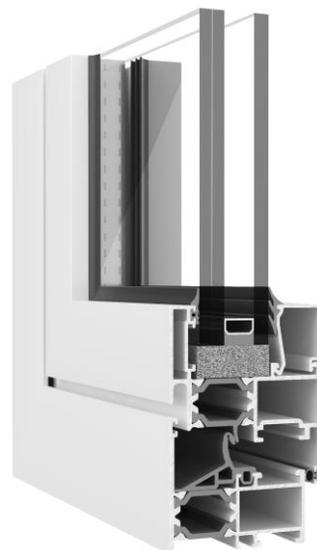
Serie practicable con Rotura de Puente Térmico, en la que tanto el marco como la hoja están constituidos por un perfil tubular compuesto de dos perfiles unidos por dos barretas aislantes de 24,8mm.
