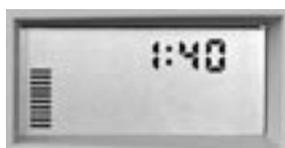
Para programar seleccione la posición Automático, oprima el botón **+** y gire el selector a la posición Regulación de Tiempos de Riego. Oprima los botones **+** y **-** para incrementar o disminuir el tiempo de demora hasta 100 segundos.
