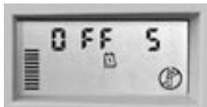
El EC permite el apagar el programador por un tiempo predeterminado
