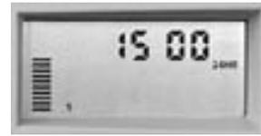
El EC permite la operación del programador en modos de AM/PM o 24 horas. Varios programadores dependen de ciclos electrónicos para determinar si la
