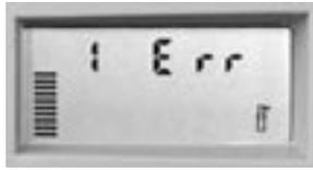
El EC está equipado con un circuito de protección contra la sobrecarga. Dicho circuito detecta la
