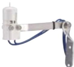
**Mini-Clik** – El modelo estándar Mini-Clik, se utiliza en la mayoría de las instalaciones. Fabricado en aluminio y termoplástico de alta resistencia. Los ajustes simples de click-stop miden con precisión la cantidad de lluvia caída, entre 3,175 mm (1/8") a 25 mm (1"). La regulación es ajustable.
