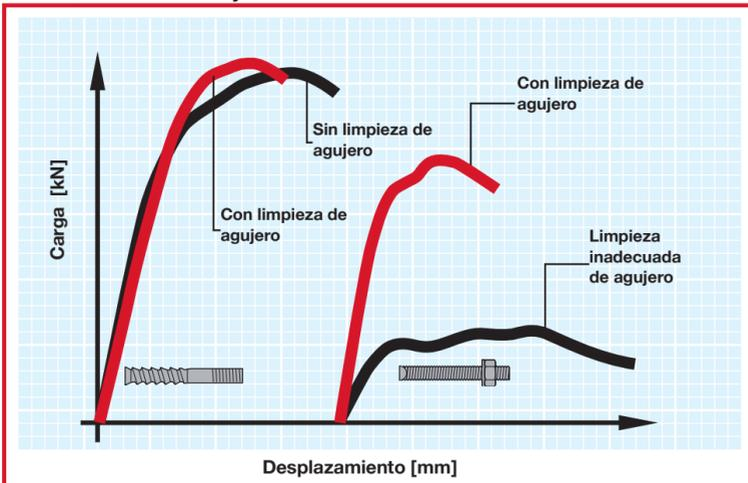
En el proceso de homologación de anclajes es obligatorio ensayar anclajes ejecutados con limpieza incorrecta. La resistencia característica del anclaje se reduce drásticamente si la diferencia entre las dos gráficas es grande. Con la nueva varilla helicoidal HIT-Z no hay reducción de carga porque no hay diferencia en la carga obtenida con un taladro adecuadamente limpio adecuadamente y uno que no lo está.
