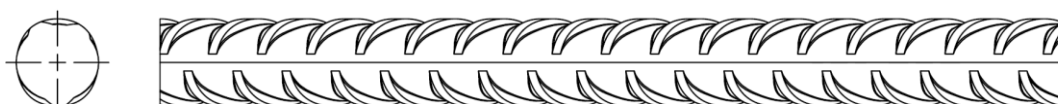
Figure 4 : Tiges métalliques – acier à béton ; 6 \text{ mm} \leq d \leq 30 \text{ mm}
